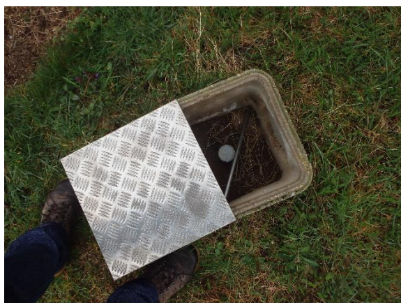
Figure 8 : tête de piézomètre (source hydratec) et coupe (source Consignes écrites BRLE)
